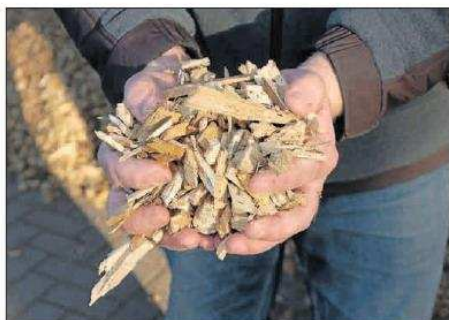
Solche Holzhackschnitzel werden im Heizkessel verbrannt.
